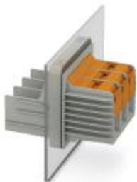
Проходная клемма, Тип подключения: Разъем T-LOX с коленчатым рычагом, Болтовые клеммы, Ток нагрузки: 232 А, Сечение: 25 мм<sup>2</sup> - 95 мм<sup>2</sup>, AWG 4 - 3/0, Направление подключения проводника к направлению вставления: 0 °, Ширина: 25,2 мм, Цвет: серый
