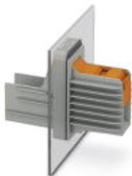
Проходная клемма, Тип подключения: Разъем T-LOX с коленчатым рычагом, Подсоединение кабельного наконечника, Ток нагрузки: 232 А, Сечение: 25 мм<sup>2</sup> - 95 мм<sup>2</sup>, AWG 4 - 3/0, Направление подключения проводника к направлению вставления: 0 °, Ширина: 25,2 мм, Цвет: серый
