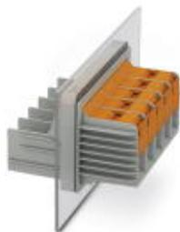
Проходная клемма, Тип подключения: Разъем T-LOX с коленчатым рычагом, Подсоединение кабельного наконечника, Ток нагрузки: 232 А, Сечение: 25 мм<sup>2</sup> - 95 мм<sup>2</sup>, AWG 4 - 3/0, Направление подключения проводника к направлению вставления: 0 °, Ширина: 25,2 мм, Цвет: серый
